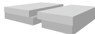
LAP (schodkový spoj) od 30 do 250 mm
